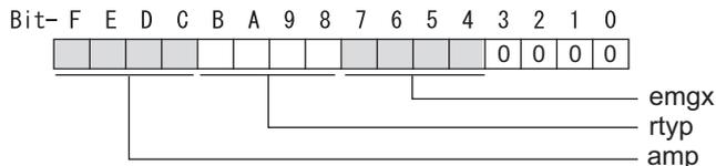
**bit F-8 : amp(bit F-C) / rtyp(bit B-8)**
